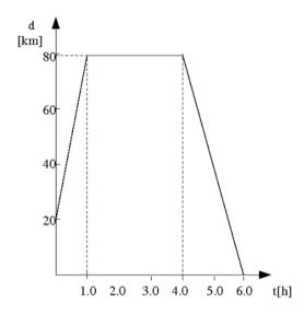
El móvil parte a 20[Km] del origen y avanza una hora, luego está detenido 3 horas y comienza a devolverse hasta llegar al origen, demorándose en total 6[h]. Este M.R.U. se divide en tres tramos: primero 0 -1,0[h] donde el móvil tiene una velocidad constante, luego de 1,0 -4,0[h] donde el móvil tiene velocidad constante cero, y finalmente el tramo 4,0-6,0[h] donde el objeto va retrocediendo a velocidad constante.
