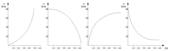
En la figura anterior de izquierda a derecha: el primer gráfico representa a un objeto que se aleja del origen y va acelerando; en el segundo un objeto que va hacia el origen y acelerando; en la tercera figura el objeto va alejándose del origen y desacelerando; en la cuarta figura el objeto va acercándose al origen y desacelerando.
